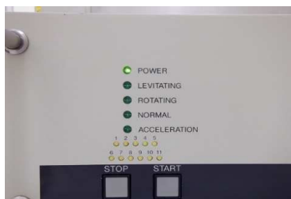
* 通電時POWER点灯(通電確認のみ実施の為、制御系の確認は未実施です。)
